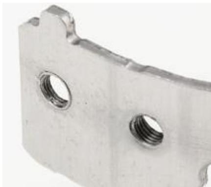
Blechgewinde wird während dem Stanzprozess erstellt
